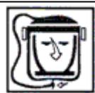
Attenersi alle disposizioni dei DPR 303 e 547. Evitare, per esempio, il contatto del prodotto con la pelle. Operare in luoghi ben areati e, se al chiuso, impiegare aspiratori, ventilatori e convogliatori d'aria. Durante l'applicazione utilizzare le adeguate protezioni (maschere, guanti, occhiali, ecc.).
